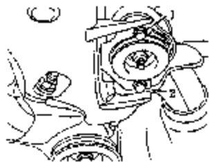
图 2-104 拧松变速器右侧悬置的螺栓
