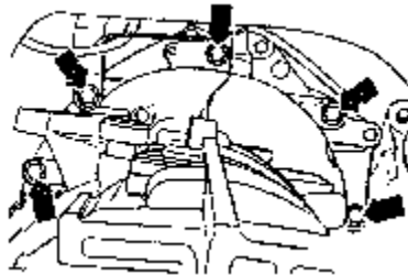
图 7-55 拆下连接螺栓
