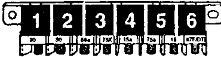
图 8-136 起动机锁死继电器 J207
