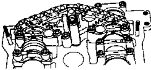
图 4-100 安装进排气凸轮轴链轮的轴承盖
