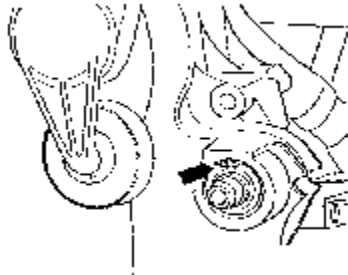
图 2-127 拆卸轴承卡簧
