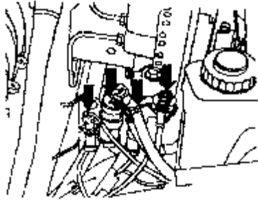
图 2-6 拔下防盗报警器、空调压缩机电磁离合器和喇叭的线束插头
