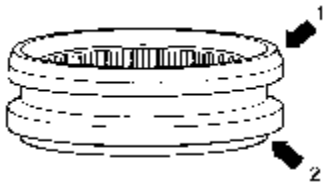
图 9-81 同步器齿套安装位置
