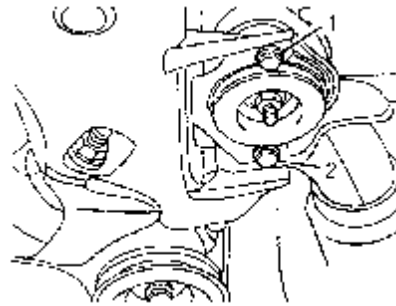
图 4-129 拆卸变速器右侧悬螺栓
