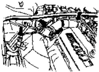
图 2-7 拔下空气流量计和油箱通电磁阀线束插接头
