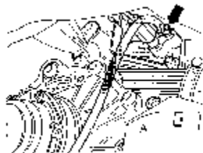
图 9-10 离合器装置排气
