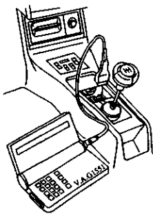
图 2-71 故障诊断仪的安装
